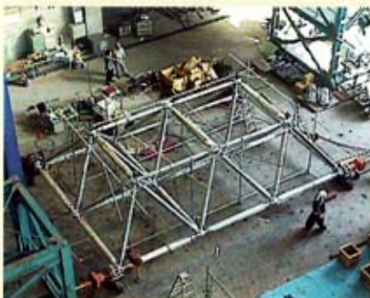
▼立体トラス耐力壁の面内せん断実験
