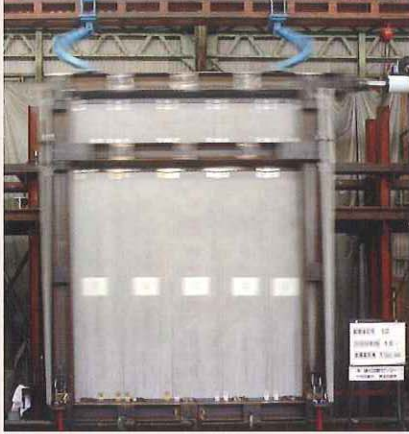
写真: 建材試験センター中央研究所における層間変位試験(強制変形角 1/50)
