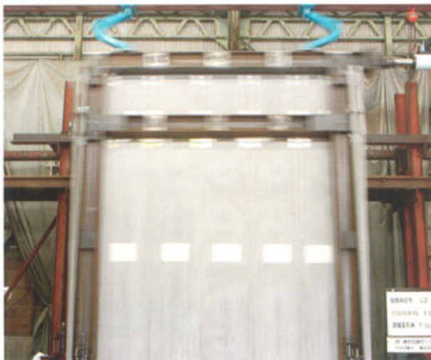
層間変位試験 (LZ金物)
