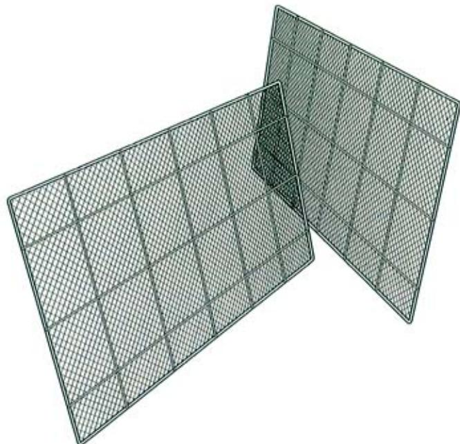
従来、基礎を作った後は板を取り外し焼却処分していたため、森林伐採や二酸化炭素（CO<sub>2</sub>）の排出などによる環境問題となっています。当社で開発した“エコウェルメッシュ”は、コンクリートを流した後もそのまま建物の基礎として使えるため、解体する必要がなく、さらに短期間で施工ができるなど、工費のローコスト化を実現しました。
