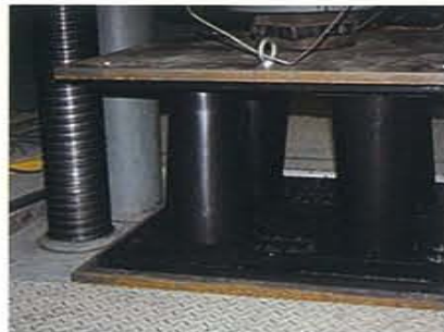
鉛直方向圧縮試験 ハイドロスタップを1枚または複数枚積み重ねた状態で圧縮試験を実施する。
