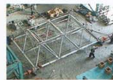
立体トラス耐力壁の面内せん断実験
